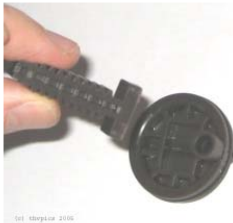
Das Symptom: Die Zahnstange hat sich vom Kolbenboden gelöst
